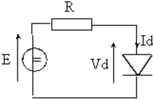
On prendra comme générateur le GBF réglé en DC (fréquence nulle). En polarisation directe, on fera varier la tension d'alimentation  $E$  de 0 à 14 V environ. Pour mesurer  $V_D$  et  $I_D$  on utilisera un voltmètre et un ampèremètre. On peut brancher l'oscilloscope au borne du générateur pour contrôler en permanence la tension d'alimentation.
