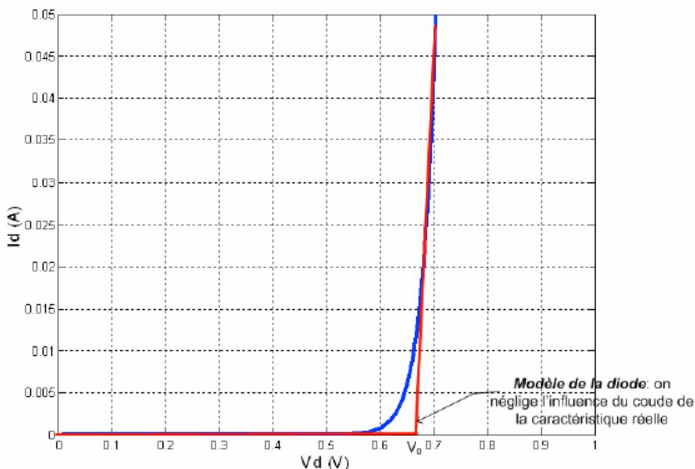
$V_0$  est l'abscisse obtenue en prolongeant la partie rectiligne AB de la courbe réelle.
