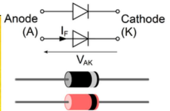
La diode est **un dipôle non-linéaire et polarisé** (ou non-symétrique). Le sens de branchement de la diode a donc une importance sur le fonctionnement du circuit électronique. La diode possède une anode (A) et une cathode (K) comme indiqué sur le schéma de droite ci-dessus.
