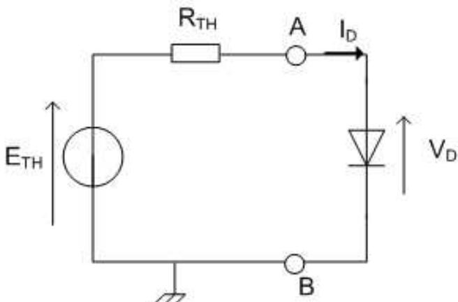
→ Pour calculer  $R_{Th}$ , il suffit de calculer la résistance équivalente au circuit gauche de (AB) avec le générateur de tension éteint (on le remplace par un fil)
