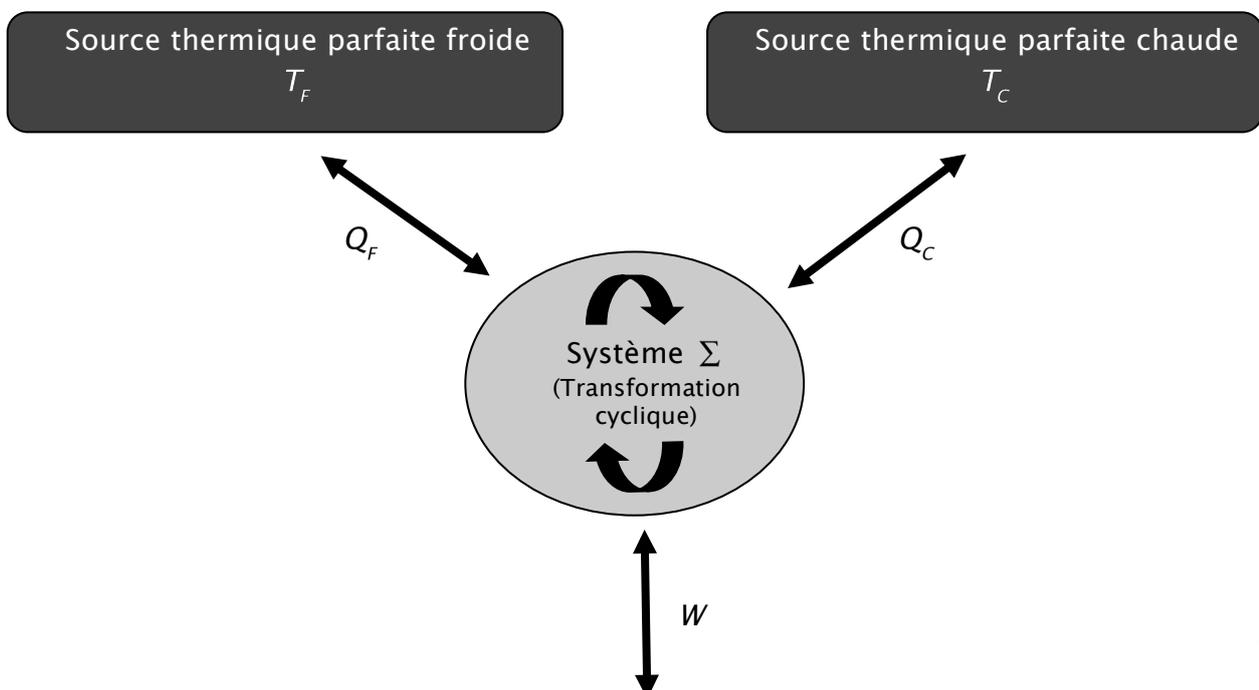
Le système  $\Sigma$  (notre machine thermique) subit une transformation cyclique. Il reçoit au cours du cycle algébriquement  $Q_F$  (échange avec la source froide),  $Q_C$  (échange avec la source chaude) et  $W$ .
