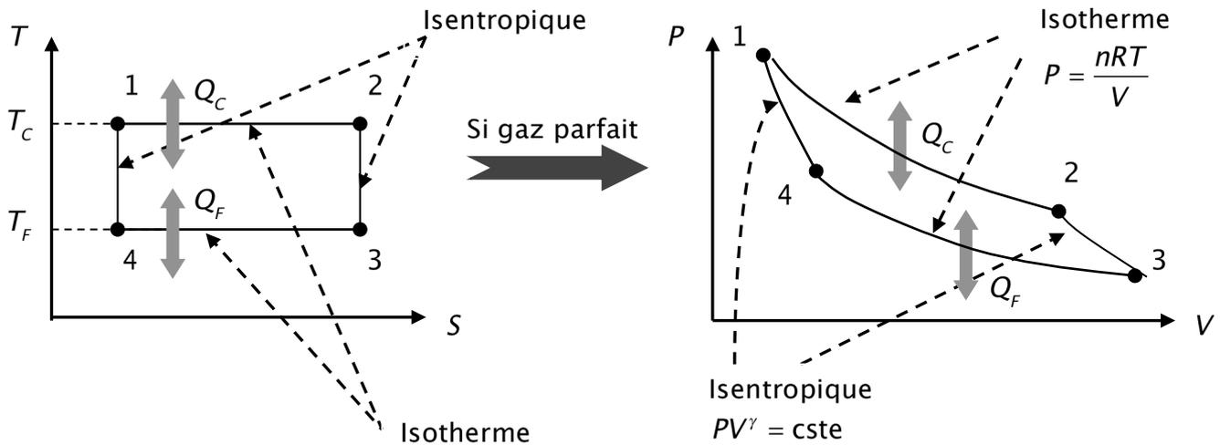
Dans le diagramme  $(P,V)$ , le cycle est en réalité très plat, l'aire du cycle est faible.
