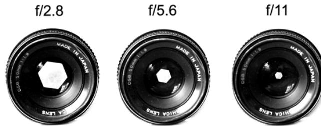
Exemples d'ouverture, sur un objectif à focale fixe standard  $f = 50$  mm
