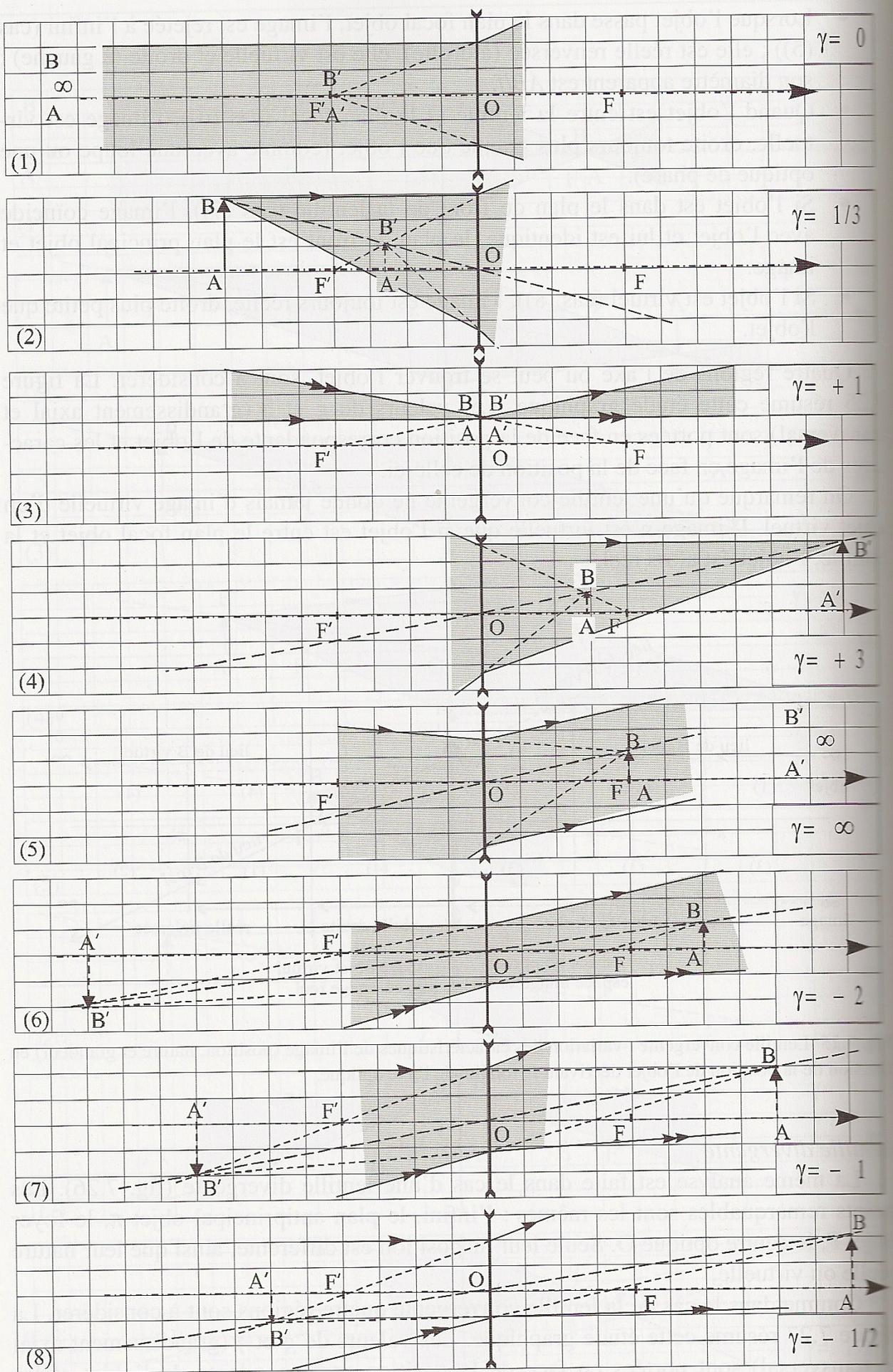
Fig. 7.26 Images d'un objet  $[AB]$  de hauteur constante, formées par une lentille divergente.
