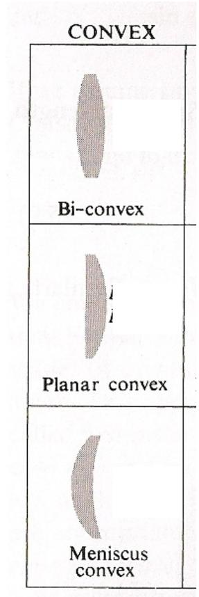
Il existe plusieurs types de lentilles convergentes : biconvexe, plan convexe, ménisque convergent (voir figures ci-contre). Nous utiliserons désormais le schéma équivalent suivant pour représenter une lentille convergente :
