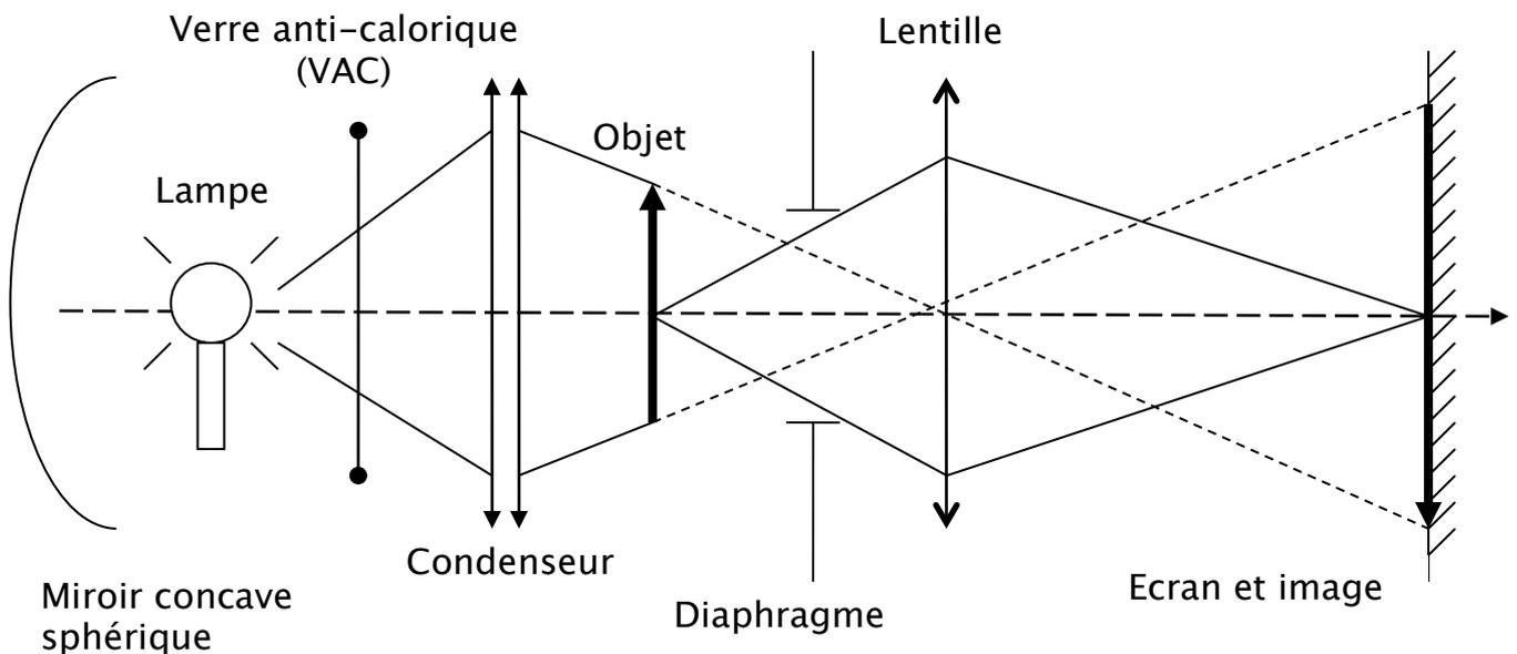
On obtient une image nette si on **diaphragme le faisceau** qui arrive sur la lentille et si **l'objet n'est pas trop éloigné de l'axe optique**. Nous sommes alors dans les conditions de Gauss, on ne garde que les **rayons paraxiaux** (peu inclinés et peu éloignés de l'axe optique). Il faut noter qu'avec le diaphragme l'image est plus nette mais elle est moins lumineuse (il faut trouver un compromis). Nous retiendrons la conclusion suivante :
