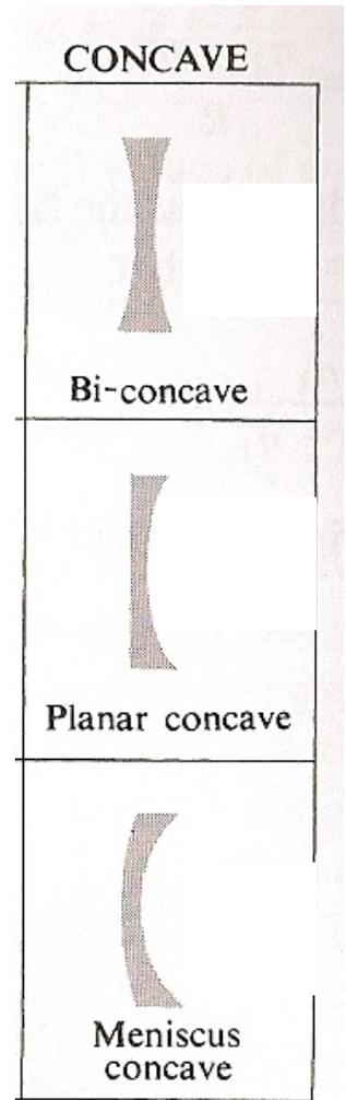
Il existe plusieurs types de lentilles divergentes : biconcave, plan concave, ménisque divergent (voir figures ci-contre). Nous utiliserons désormais le schéma équivalent suivant pour représenter une lentille divergente :
