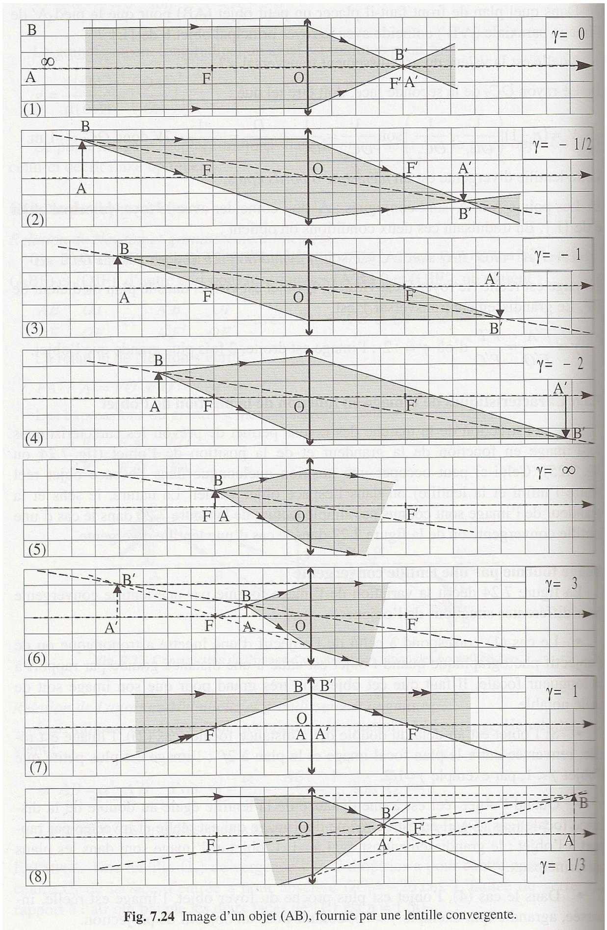
Fig. 7.24 Image d'un objet (AB), fournie par une lentille convergente.
