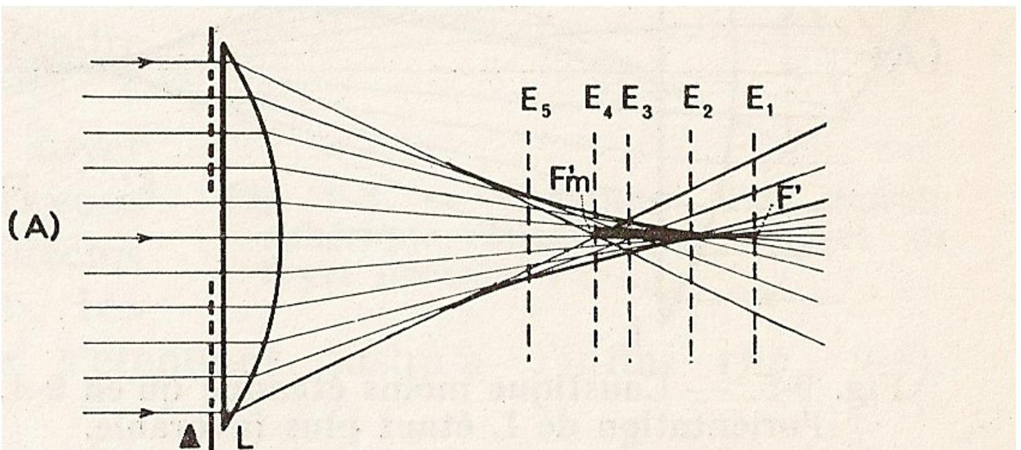
Fig. 9-4. — Caustique d'une lentille, pour un point objet très éloigné, sur l'axe. La section du faisceau par le plan  $E_1$  présente un maximum de lumière en  $F'$  (foyer marginal); en  $E_2$ , tache centrale élargie; en  $E_3$ , cercle minimum; de  $E_4$  en  $E_5$ , anneau plus lumineux que le centre.
