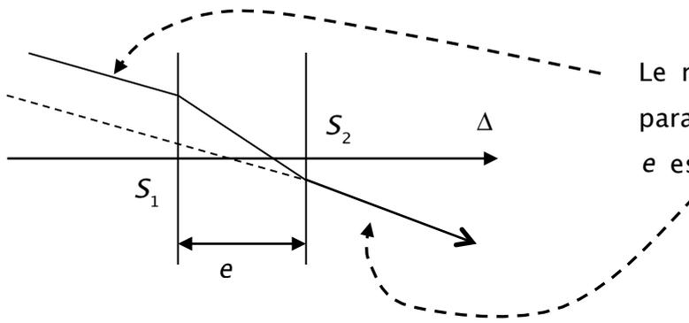
Le rayon émergent et le rayon incident sont parallèles. Le décalage devient négligeable si  $e$  est faible.
