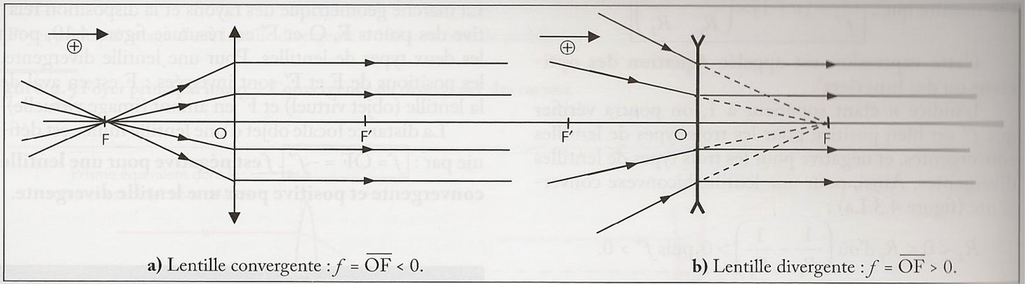
**Figure 4.10** Foyer principal objet – Marche géométrique des rayons et disposition relative de F, O et F'.
