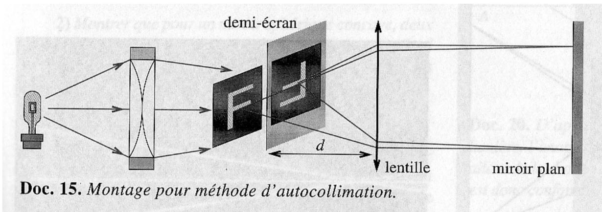
Il existe aussi des images parasites dues à la réflexion de la lumière sur les faces de la lentille. Pour éliminer ces images, il suffit de tourner légèrement le miroir. La position de la véritable image ne change pas alors que la position de l'image par réflexion sur le miroir se déplace.
