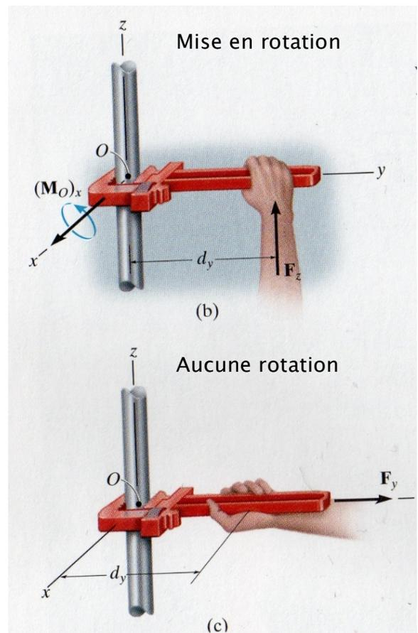
Figure a,b,c : Effet d'un moment d'une force.
