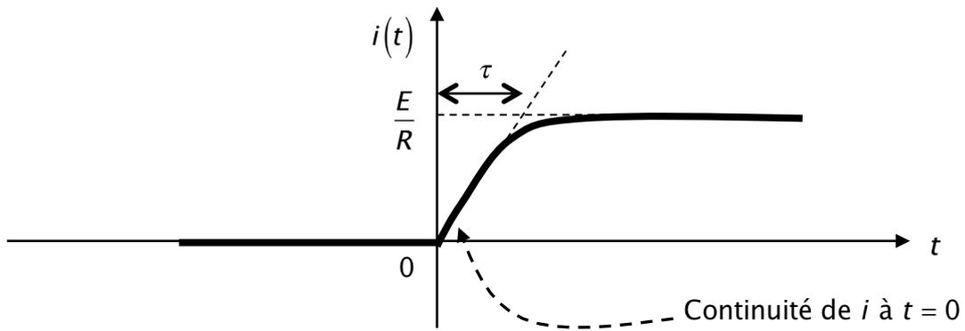
Nous allons déterminer  $u_L(t)$ .  $u_L(t) = L \frac{di}{dt} = \frac{L E}{\tau R} e^{-\frac{t}{\tau}} = E e^{-\frac{t}{\tau}}$ .
