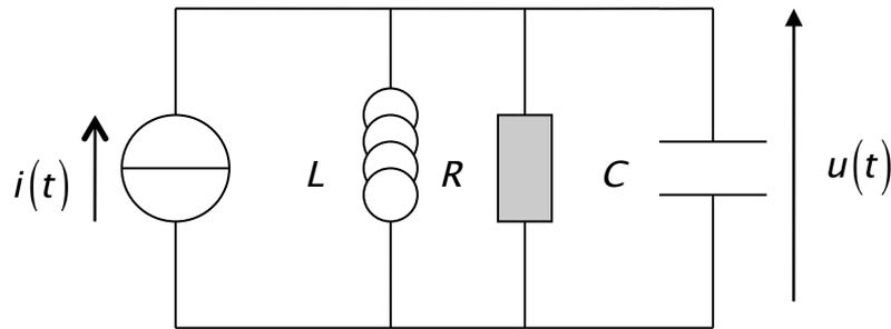
Le générateur de tension fournit un courant sinusoïdal de la forme  $i(t) = I_m \cos(\omega t)$  connu.
