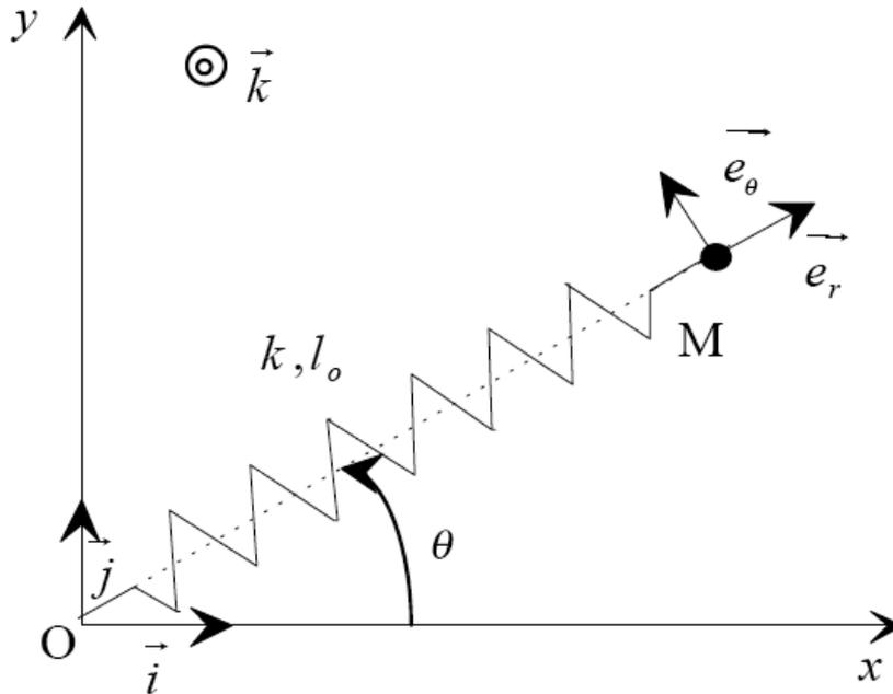
Le mouvement est étudié dans le référentiel du laboratoire assimilé à un référentiel galiléen et associé à un repère  $(O, \vec{i}, \vec{j}, \vec{k})$ . Un palet  $M$  de masse  $m$  peut se mouvoir sans frottement dans le plan  $(O, x, y)$  horizontal (table à coussin d'air par exemple). Le champ de pesanteur est suivant la verticale  $Oz$  :  $\vec{g} = -g\vec{k}$ .
