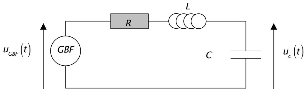
Déterminer la pulsation  $\omega$  du GBF (en fonction des données du problème) qui rend l'amplitude de la tension aux bornes du condensateur maximale.
