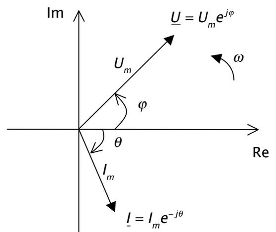
On peut donc représenter une amplitude complexe par un vecteur dans un **diagramme dit de Fresnel** (figure ci-dessus). Sur ce dernier, l'amplitude complexe  $\underline{U}$  est une « photo » à l'instant  $t = 0$  du nombre complexe  $\underline{U}e^{j\omega t}$ , dont la partie réelle correspond à  $u(t)$ . Ainsi, dans le plan complexe,  $\underline{U}e^{j\omega t}$  a un mouvement de rotation à la vitesse angulaire  $\omega$  dans le sens trigonométrique.
