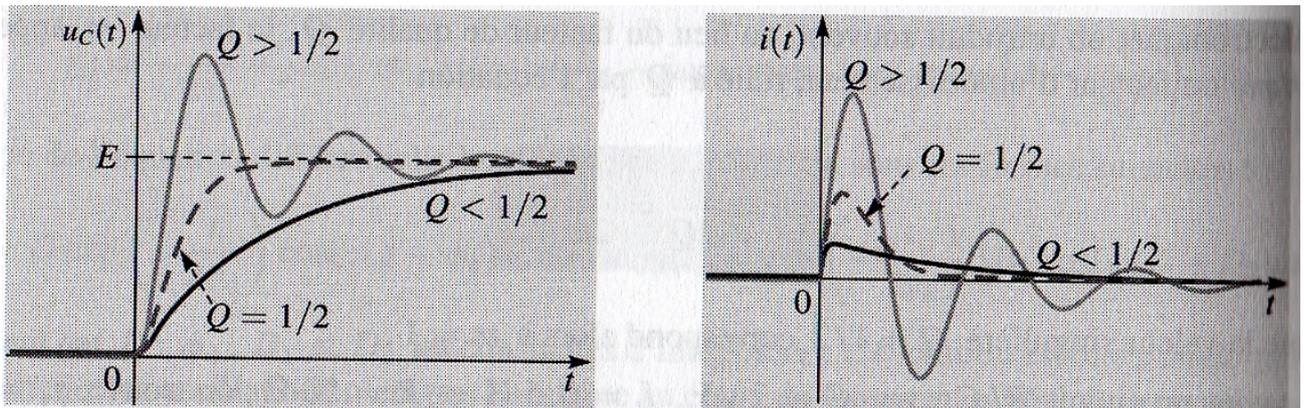
Quand  $t \rightarrow \infty$ , le condensateur se comporte comme un interrupteur ouvert et la bobine comme un fil sans résistance (bobine idéale) donc  $i \rightarrow 0$  et  $u_c \rightarrow E$ .
