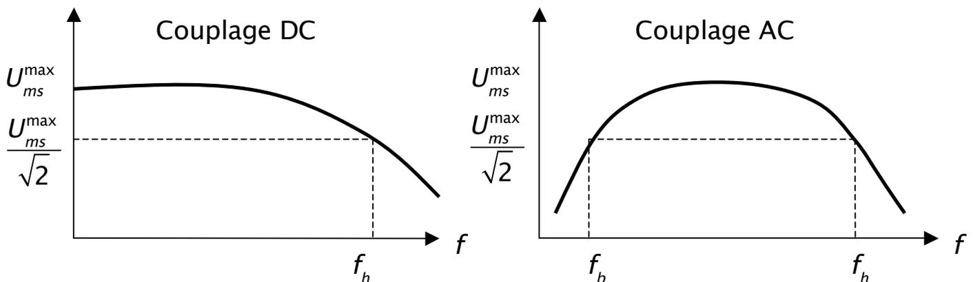
$f_b$  et  $f_h$  sont les **fréquences de coupure** respectivement basse et haute de l'oscilloscope. ( $f_b = 0$  en DC).  $\Delta f = f_h - f_b$  est la **bande passante** de l'oscilloscope.
