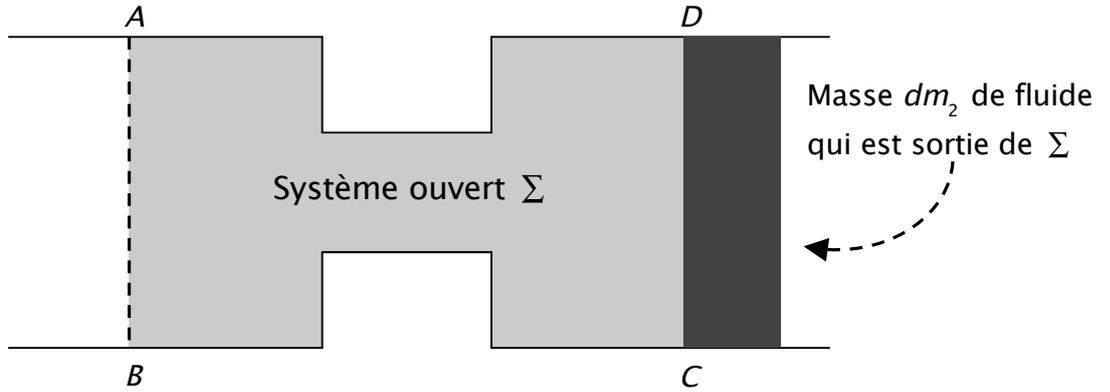
Le système  $\Sigma^*$  contient une masse  $M^*(t)$ , une énergie interne  $U^*(t)$  et une énergie mécanique  $E_m^*(t)$ .
