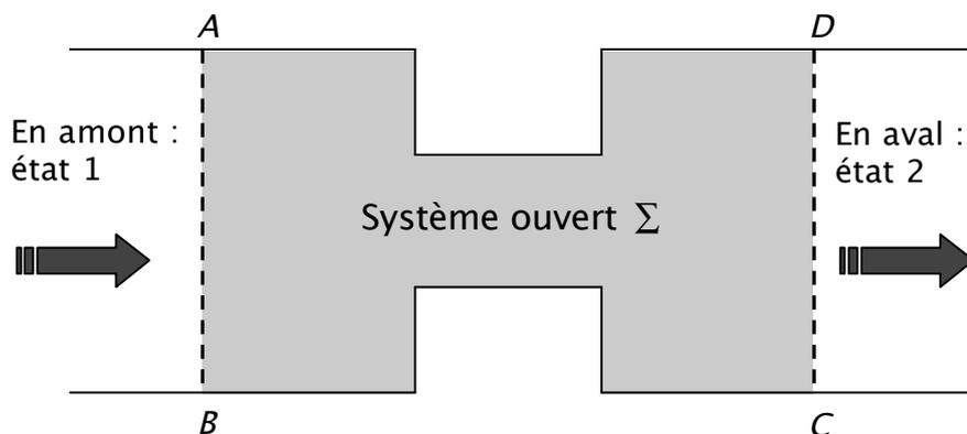
La portion de la canalisation ABCD constitue un **système ouvert**  $\Sigma$  puisque de la matière y rentre et en sort en permanence. On parle aussi de **volume de contrôle** pour désigner les systèmes ouverts.
